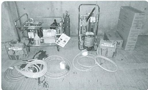
浄水装置 機械式(左)手動式(右)
